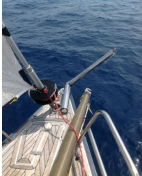
ULTERIORE RAMMARICO, IL BOMPRESSO NUOVO CEDE DI SCHIANTO CON ARIA A 10 NODI
